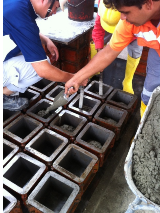
混凝土方塊試驗
