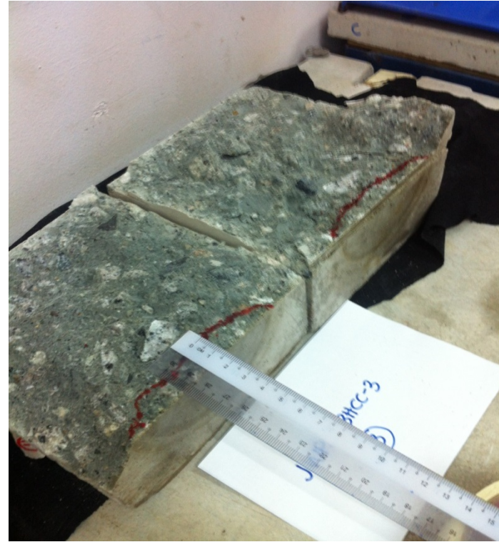
劈開試體, 觀測透水深度
