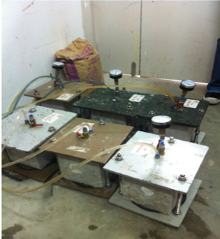
方塊試體執行水壓測試, 靜態水壓力5 bar, 持續72小時
