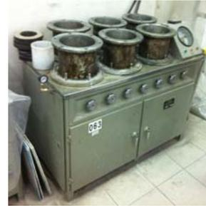
圖 4 抗滲試驗儀器
