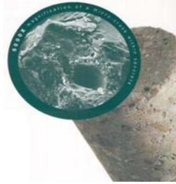
圖 1 混凝土內部孔隙圖[2]
